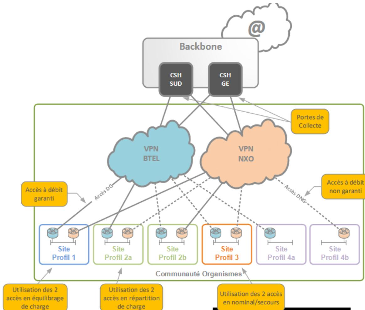
Le routage se fait via le protocole BGP (Border Gateway Protocol). Les équipements ne sont pas uniformes : routeurs (couche 3) et commutateurs (couche 2/3) différents selon les sites, entraînant plusieurs problèmes tels que des fabricants différents, versions d'OS variées, besoins de formations spécifiques et problèmes d'incompatibilité. La gestion s'effectue de la Direction
