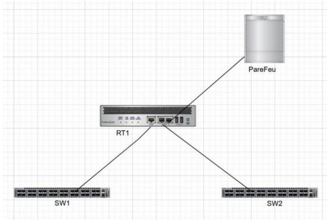
L'infrastructure existante se compose d'un PareFeu, d'un routeur et deux switches.
